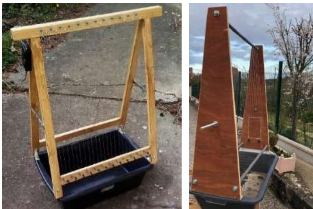
Fig 2. De façon similaire, la harpe mise au point par AAVO est constituée de fils écartés de 23 mm.
